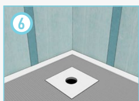
6 В местах выхода труб из пола наклеить манжету TH2 Stop Floor Collar
