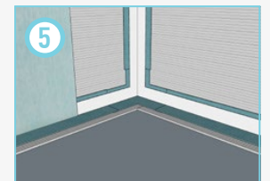
5 Наклеить на всю поверхность стен мембрану TH2 Stop
