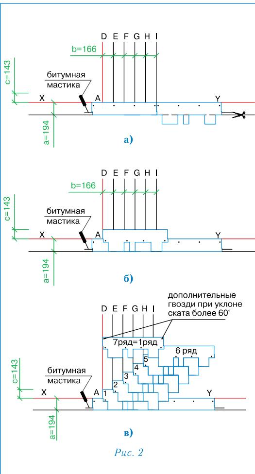
Для монтажа кровельного покрытия необходимо ровное, сухое и чистое основание, которое может быть выполнено из ОСП (ориентированно-стружечной плиты), фанеры повышенной влагостойкости, шпунтованной, обрезной доски, железобетонных плит и т.д. Стыки элементов основания следует располагать вразбежку с зазором 3–4 мм, при этом перепады по высоте не должны превышать 2 мм.
